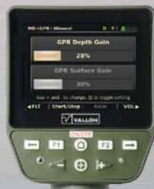
Configuration individuelle du radar (GPR). Point de départ et point d'arrêt de la zone de détection du radar, gain surface et gain profondeur.
