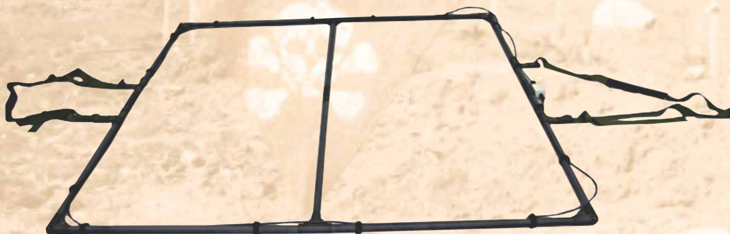
VMX10 avec tête de détection 2x2 m (exemple)
