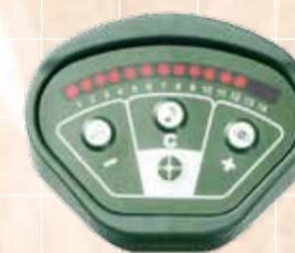
Dans le mode "metal discrimination" la déflexion à gauche ou à droite indique par exemple les métaux ferreux et non-ferreux.
