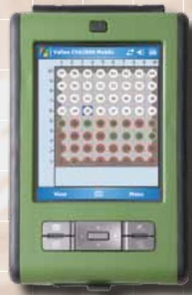
Plan de trous de forage sur le PDA
